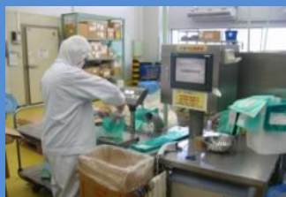
Đối chiếu nhãn ghi trên nguyên liệu và túi chia nhỏ bằng máy đọc mã vạch
